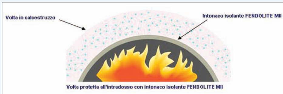
Figura 11 - La soluzione tecnica Cafco Fendolite MII
